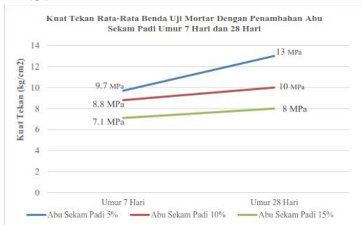
Gambar 4.5 Grafik Kuat Tekan Rata-Rata Benda Uji Mortar Dengan Penambahan Abu Sekam Padi Umur 7 Hari dan 28 Hari
