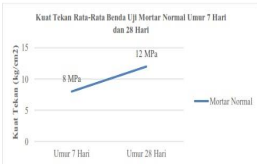
Gambar 4.4 Grafik Kuat Tekan Rata-Rata Benda Uji Mortar Normal Umur 7 Hari dan 28 Hari
