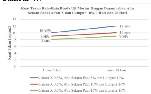
Gambar 4.7 Grafik Kuat Tekan Rata-Rata Benda Uji Mortar Dengan Penambahan Abu Sekam Padi, Cairan X dan Lumpur 10% Umur 7 Hari dan 28 Hari
