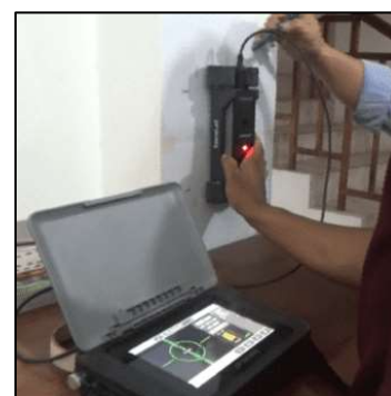
Gambar 21. Pemeriksaan Ultrasonic Profometer
